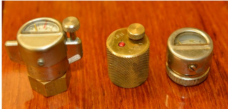
**Abbildung 12: Verschiedene Manometer, links Petromax mit Adapter für Optimus (Firma Stuga Cabana), Mitte ein Ventildeckel der Firma VDO für den Petroleumkocher für Streitkräfte der Firma Geniol (gleiches Gewinde wie Petromax), rechts Optimus.**
