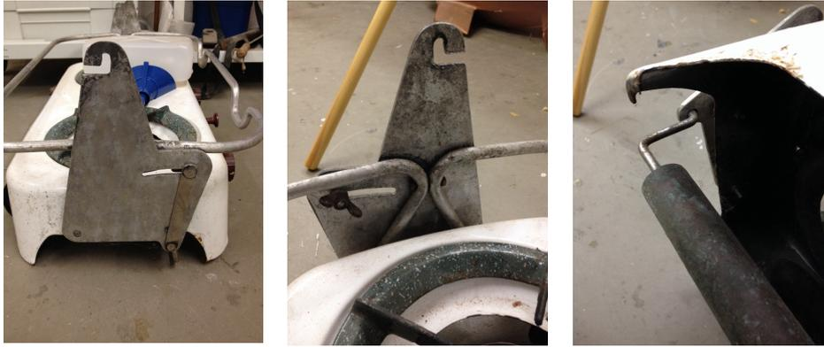
Abbildungen 23 - 25: Kocherkardanik Nr. 2121 bestehend aus Seitenteilen sowie daran befestigtem Ausgleichsgewicht an einem Optimus 535
