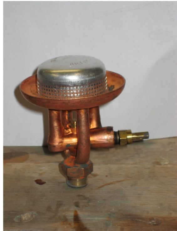
Abbildung 1: Zeichnung und Foto eines Optimus 207B Brenners
