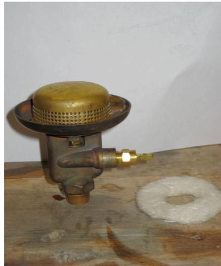
Abbildung 3: Cobra Brenner Typ 9007, Fa. Optimus, mit zu montierendem Ring aus Glaswollefloss
