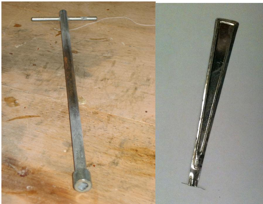
Abbildung 16: Schlüssel für Düse/Bodenventil (Nr. 2561) (links) sowie Düsennadel (rechts).
