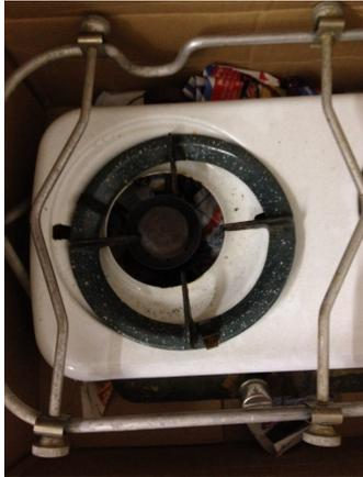
Abbildung 17: Schlingergestell Nr. 2055 mit Topfhalter aus dem Paket 2120 an einem Optimus 535
