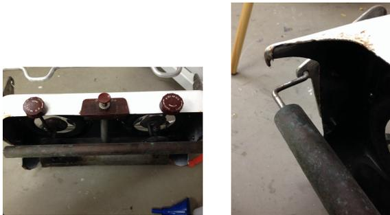
Abbildungen 26 & 27: Ausgleichsgewicht montiert an einem Optimus 535
